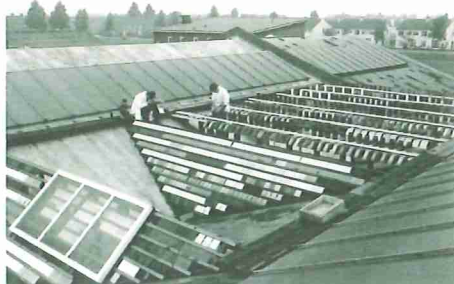
Wat doet kleur onder invloed van de zon? Proefpanelen op het dak van de fabriek van toen moeten dat uitwijzen.
